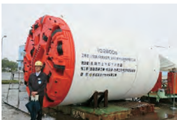
浸水対策工事(シールドマシン)
